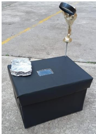
Fig. 4.44 Tabla con diseño y construcción del prototipo incorporando una lupa
