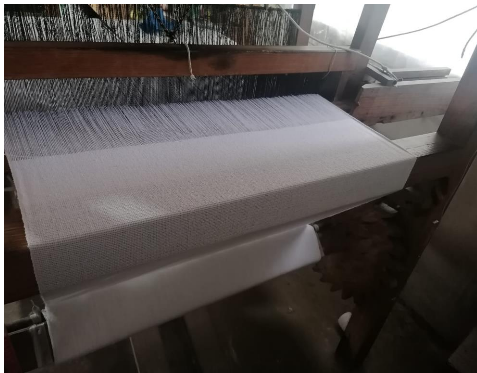
Anexo 5. Telar artesanal, el que se ocupa para sacar el lienzo del chal.
