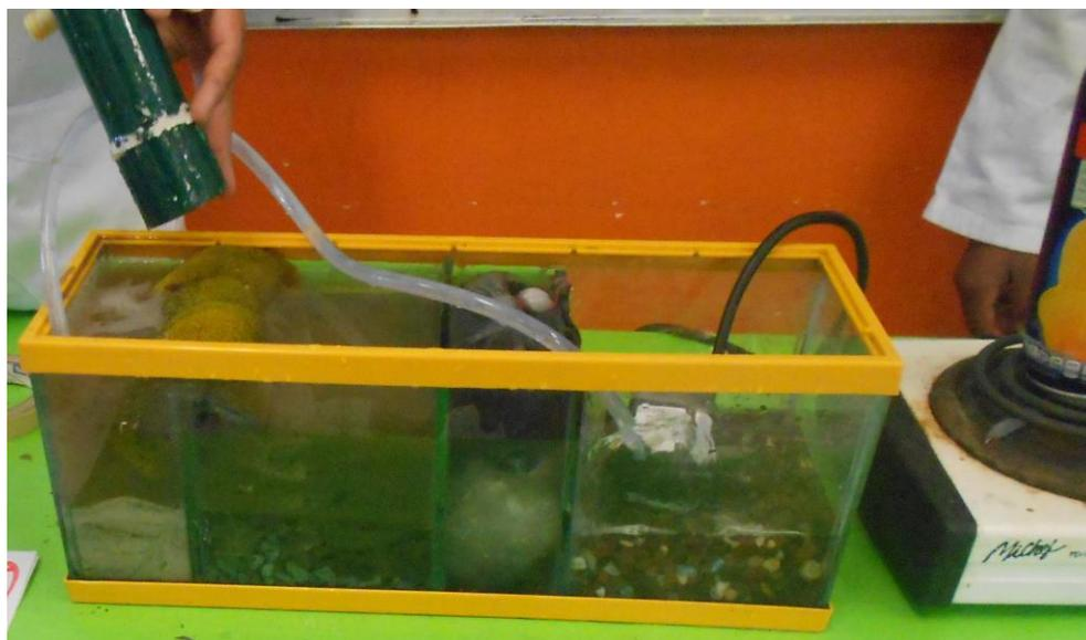
Descripción: En la imagen observamos que los alumnos presentan el producto del proyecto grupal. Muestran un método de filtración para purificar el agua utilizando materiales reciclados. Construyen con estos varias capas diferentes por donde se filtra el agua (usan carbón activo para quitar el olor, fibra para quitar las partículas grandes).
