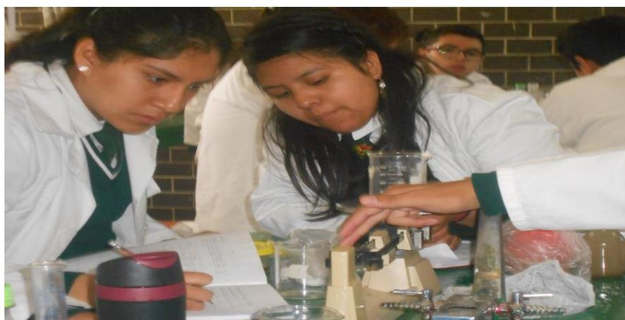
Descripción: En la imagen observamos que las alumnas utilizan una balanza para determinar la masa del agua, aceite, miel y de diferentes tipos de aguas. Este proceso
