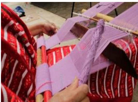
Imagen 14. Espacio generado por el machete para introducir la trama.
