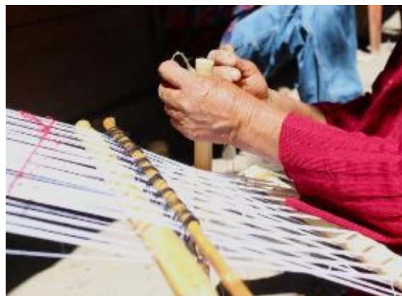
Imagen 13. Separador, para poder controlar los hilos de la urdimbre.
